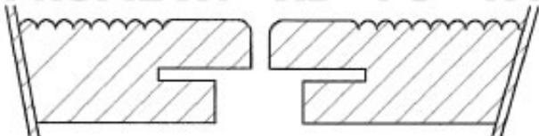
Pour une pose par clips de fixation en métal inox A2
