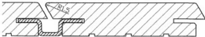
Un profil à angle à 45 ° qui masque les clips et les lambourdes car venant en recouvrement. Version rainurée sur devis.
