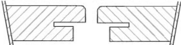
Pour une pose par clips de fixation en métal inox A2
